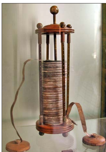
FIGURA 2. Imatge d'un prototip de pila de Volta (Tempio Voltiano, Como, Itàlia). Reproduït de https://ca.wikipedia.org/wiki/Pila_voltaica i https://commons.wikimedia.org/w/index.php?curid=2249821 (GuidoB, CC BY-SA 3.0).
