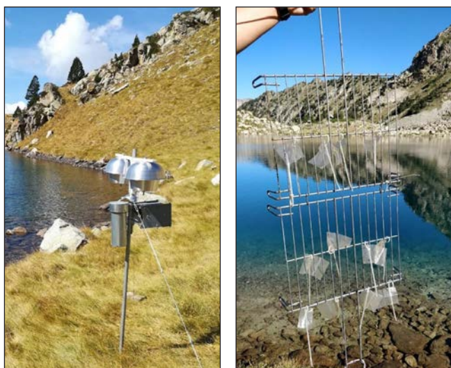
FIGURA 4. Dispositius de mostreig passiu d'aire amb escumes de poliuretà (PAS-PUF, esquerra) i d'aigua amb làmines de polietilè de baixa densitat (PWS-LDPE, dreta). Fotografies: Raimon M. Prats.
